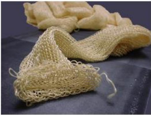
Figure 1-6 : Renfort tricoté issu d'un procédé de tricotage circulaire
