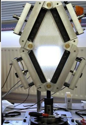
Picture Frame avec tension contrôlée
